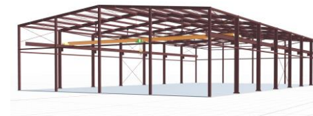
Каркас производственного здания с кран-балкой, 1008 кв.м
